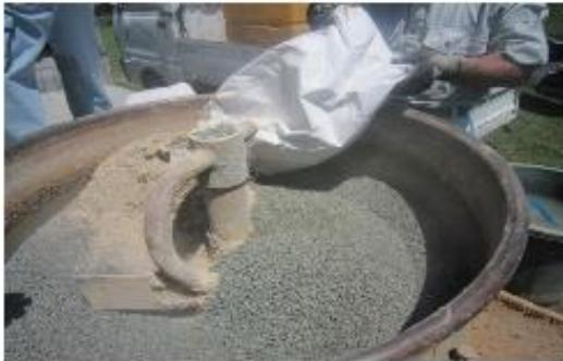
骨材と硬化液が攪拌で来たたら粉袋(18 kg)を投入します。
